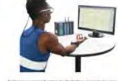
Systeem waarmee hartslag, huidtemperatuur, huidvochtigheid en andere fysiologische metingen op een met draadloze manier.
